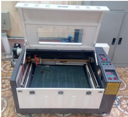
Hình 1. Thiết bị cắt vải bằng laser- ĐHSD
