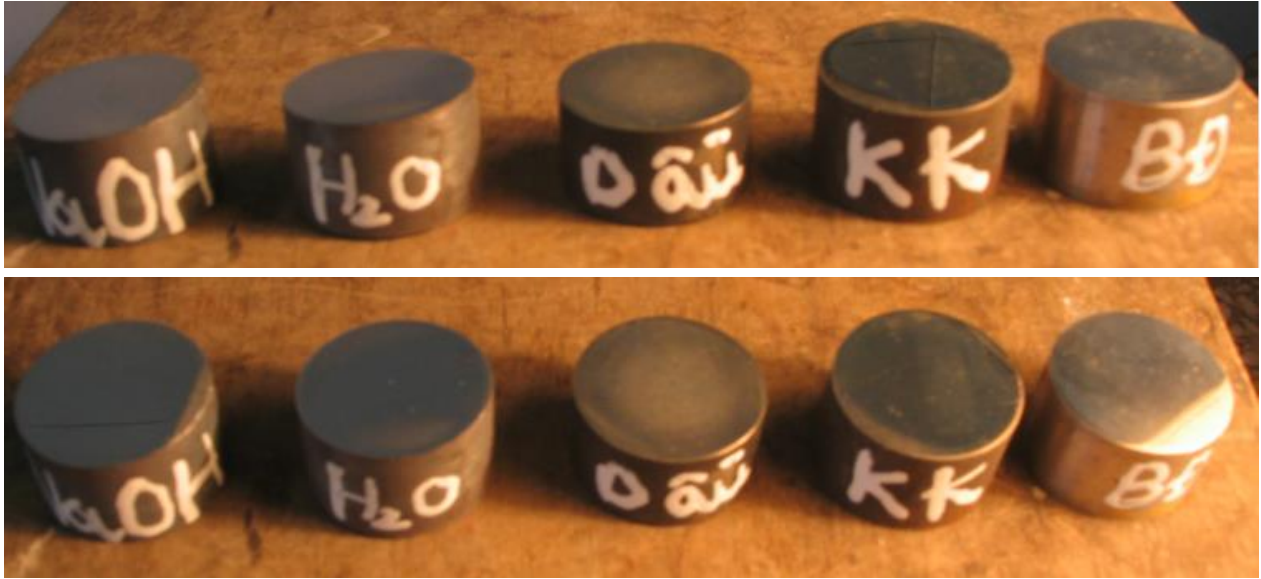
Hình 7: Các mẫu được mài sau khi tôi
