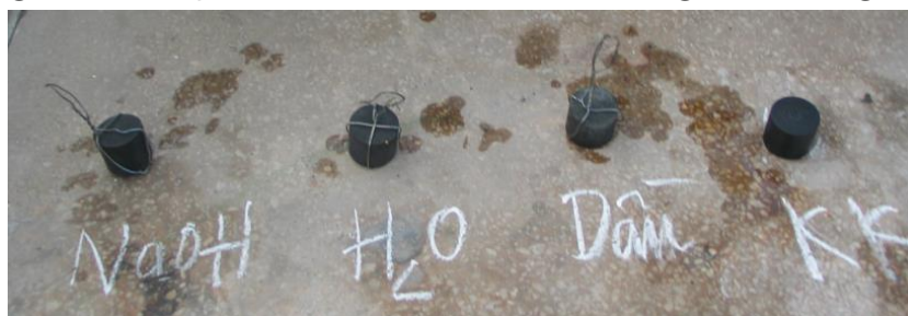
Hình 6: Các mẫu sau khi làm nguội trong các môi trường khác nhau.
