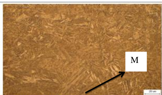
Hình 14 :Tổ chức tế vi mẫu thép C45 làm nguội trong môi trường H 2 O (x500)
