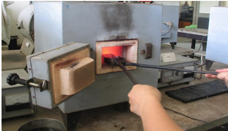
Hình 3: Thép C45 được đưa vào trong lò tôi
