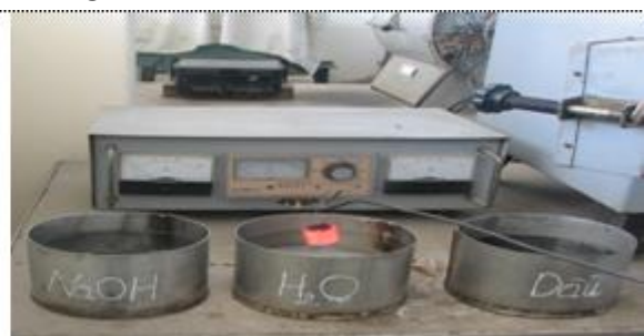
Hình 5: Chi tiết được lấy ra làm nguội trong môi trường nước
